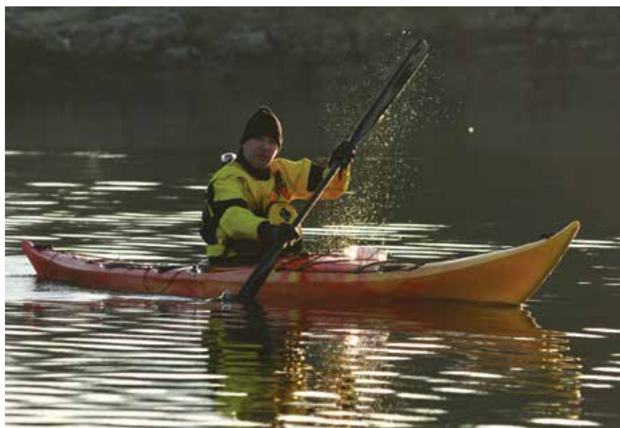
▲ Klassisk haukajak med høy baug. Dette gjør Ysak enkel å padle i bølger.
