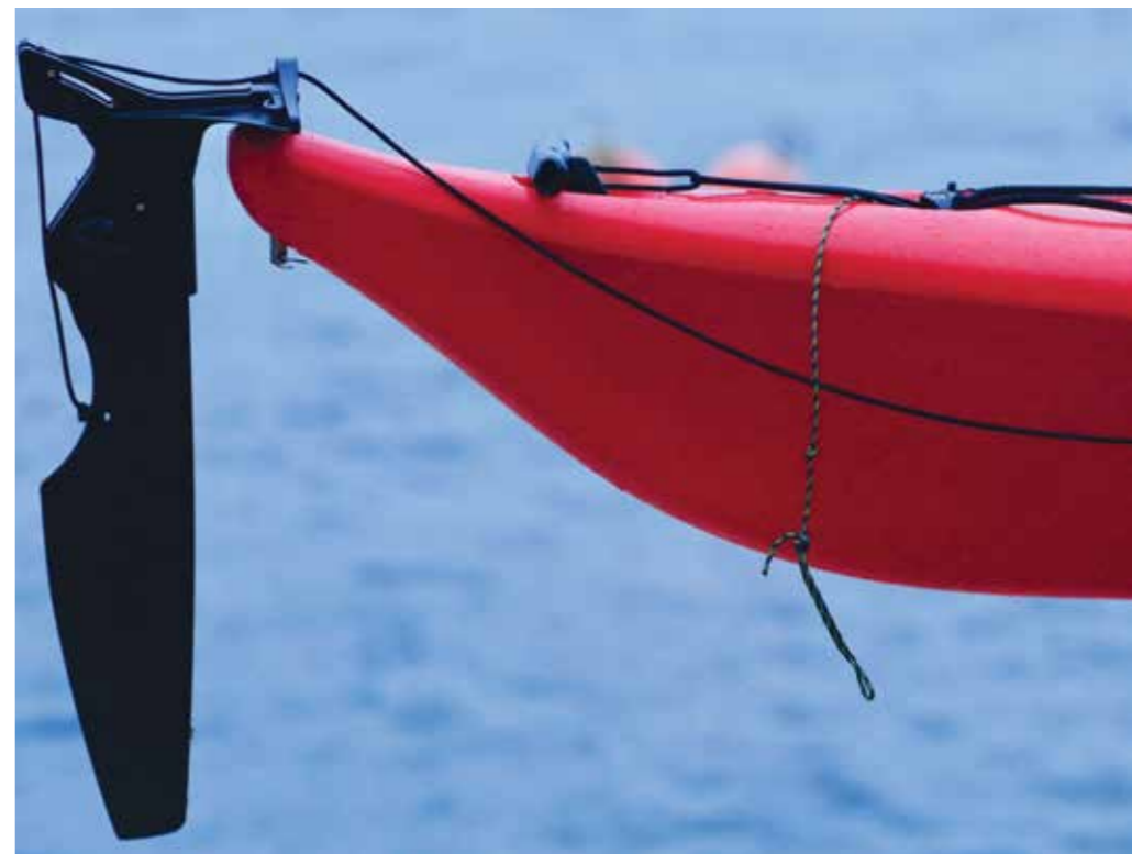
▲ Roret er langt , og typisk for slike kajaker er virkningsområdet plassert langt bak. Det virker som det skal, men kajakken klarer seg utmerket uten.
