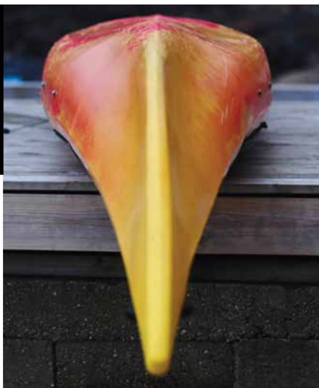
▲ Bunnprofilen er suakt u-formet med gode runde sider som gir et meget bra stabilitetsmønster.
